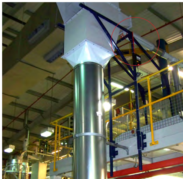
Модель Fraser 6000 Ion tube змонтована до сепаратора
