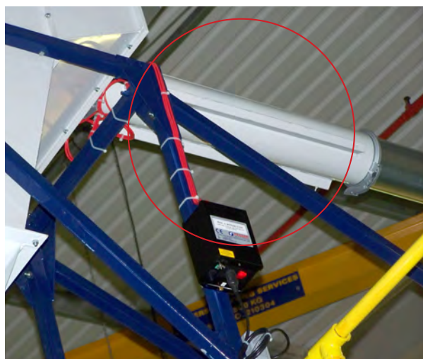
Модель Fraser 6000 Ion tube змонтована до сепаратора
