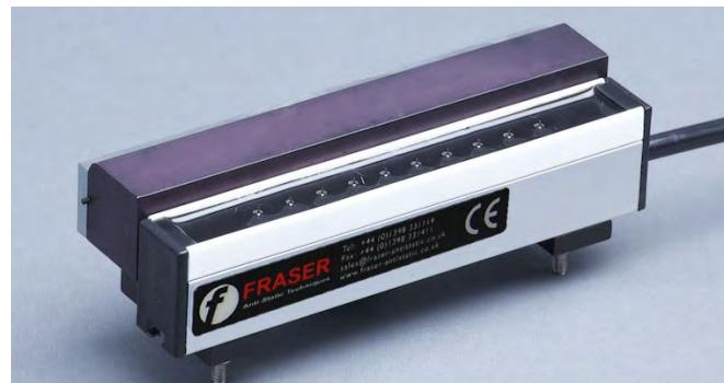
Потік іонізованого повітря з антistатичної системи має бути спрямованим між верхнім листом стопи та нижньою стороною піднятого аркуша й повинен працювати на підтримку стандартних систем роздуву, встановлених на заводі. Повітря може бути імпульсним лише для роботи під час циклу відокремлення листа від стопи та витягування його вперед на конвеєр.
