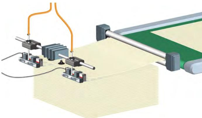
Є два типових рішення, одне з яких полягає в тому, щоб прикріпити пару іонізуючих повітряних ножів Fraser 5000 до задньої поперечини деки подачі аркушів. Для невеликих пристрійв подачі аркушів аналогічна система виготовлена з компактного іонізуючого повітряного ножа моделі Fraser 4400.
