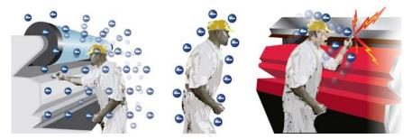
При ходьбі в електричному полі навколо рулону тіло оператора заряджається завдяки індукції. Заряд не може стекти на землю через ізоляційне взуття.
